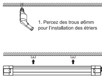
1. Percez des trous  $\varnothing 6\text{mm}$  pour l'installation des étriers
