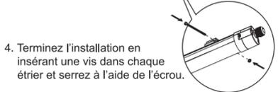
4. Terminez l'installation en insérant une vis dans chaque étrier et serrez à l'aide de l'écrou.
