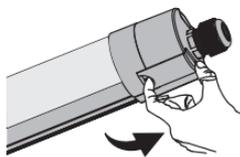
1. Soulevez les clips latéraux pour déverrouiller l'embout
