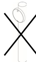
Le luminaire doit être installé sur une surface plane.
